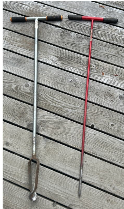
Abbildung 7: Werkzeuge für die Bodenuntersuchung © Joey Trennhaus
